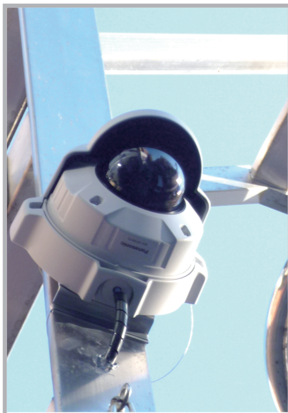
防犯カメラ (屋外対応ドームネットワークカメラ WV-SFV611L) 取り付けけた防犯カメラのスペック
